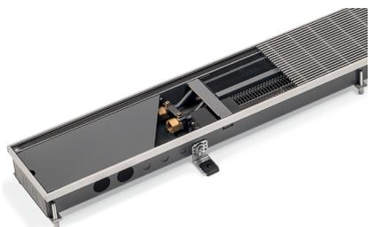
Das Gerät ist in verschiedenen elektrischen Ausstattungsvarianten lieferbar. Der Anschluss erfolgt über eine Klemmleiste im Elektroanschlusskasten. Dieser befindet sich an der Seite des Wasseranschlusses des Geräts. Die Verdrahtung ist dem jeweiligen Schaltplan, unterschiedlich je nach Ausführung, zu entnehmen.
