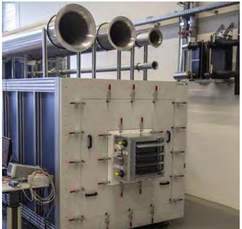
Kammerprüfstand für Luftleistungsmessungen nach EN ISO 3745 (früher DIN 24163);
