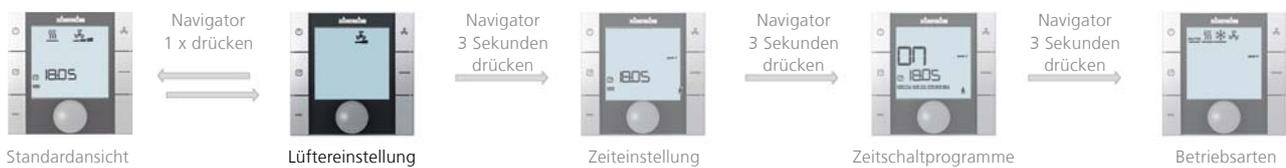
Im Automatikbetrieb wird die Raumtemperatur zunächst mit natürlicher Konvektion und anschließend durch eine stetige Anpassung der Lüfterdrehzahl geregelt.
